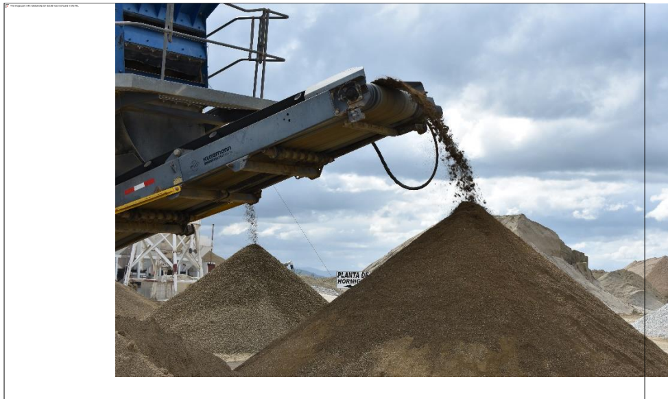
Presa La Piña Equipo para clasificación de agregados
