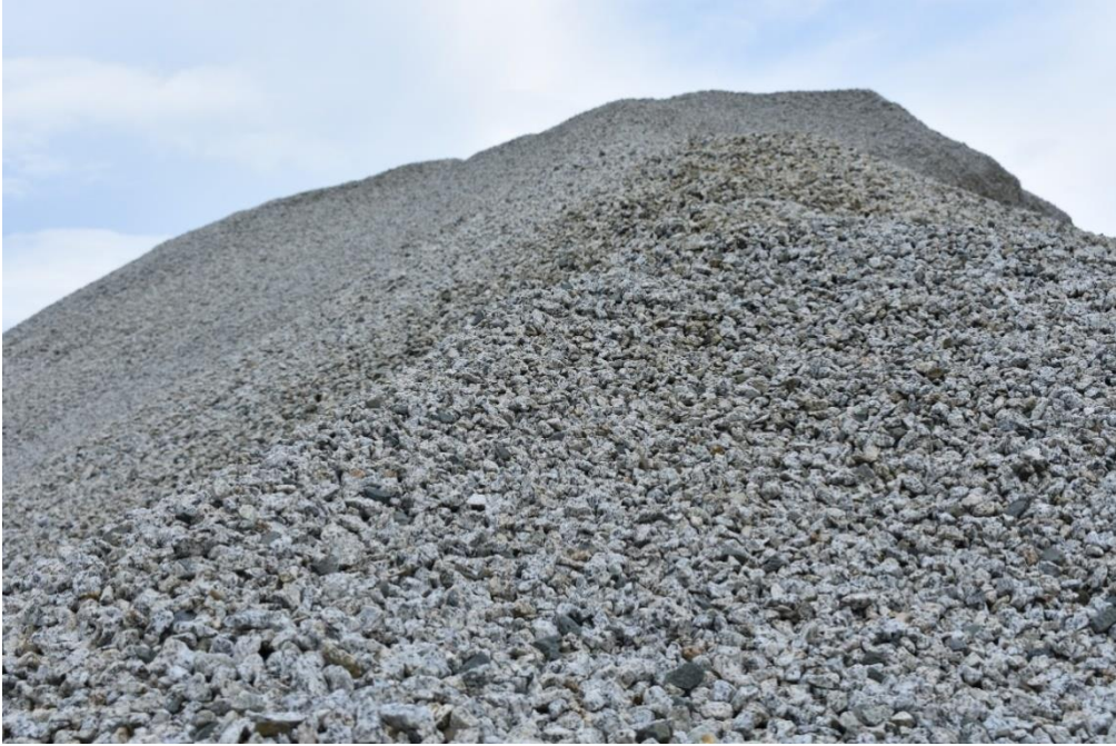
Presa La Piña Acopio material enrocamiento de la Presa
