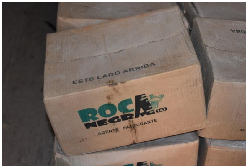
Presa La Piña Facturador Negro, aplicado para rotura de roca Tonalita 1
