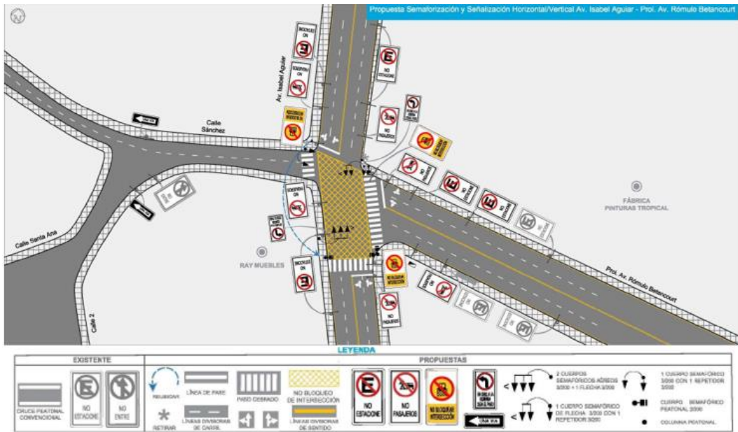
Plano 6. Propuesta Semaforización y Señalización Horizontal y Vertical Av. Isabel Aguirre – Av. Rómulo Betancourt.
