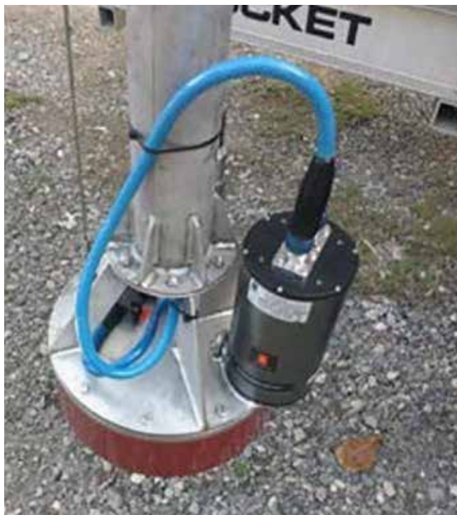
Fig. 4. Imagen de la sonda instalada en la lancha preparada para trabajos a baja profundidad.
