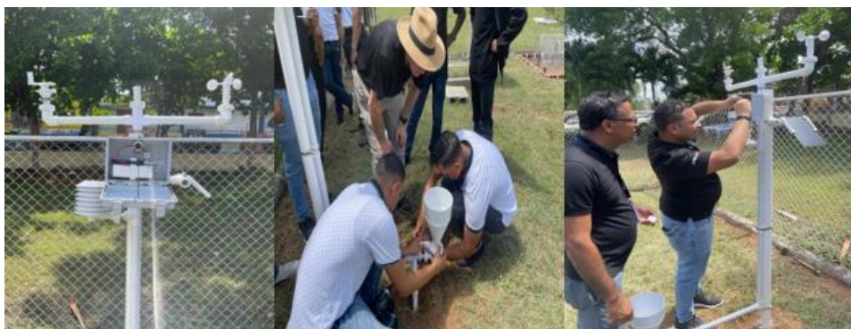
Imagen 41: Proyecto UCARS, fabricación e instalación de Estaciones Meteorológica Automática de bajo costo.
