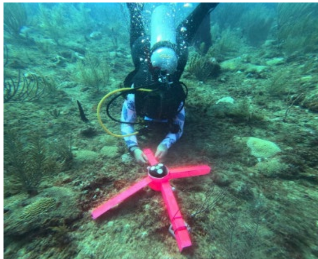
Figura 5. Colaborador de la ANAMAR instalando el perfilador acústico ADCP modelo ECO sobre el arrecife.
