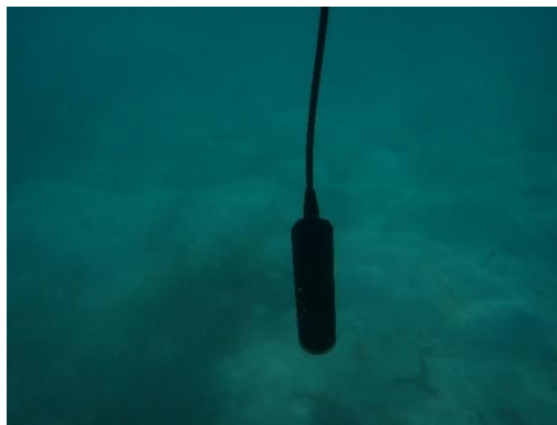
Figura 48. Toma de muestra de parámetros fisicoquímicos con el equipo de medición multiparámetros YSI, modelo ProQuatro.
