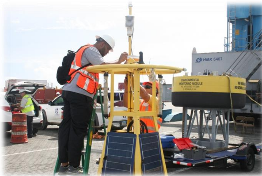
Imágenes: Instalación de las boyas en las costas de Puerto Plata y Boca Chica.
